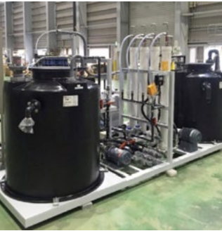
給水支援活動において使用される緊急時浄水設備「クリタレスキュー」
