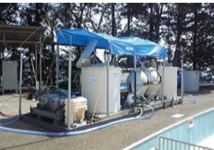
東日本大震災時に活躍した海水淡水化装置
